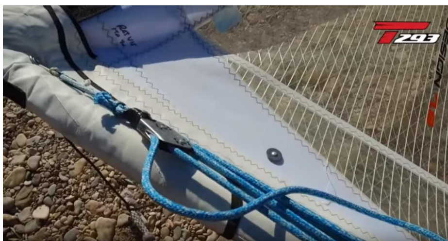
Trimovací systém na sťažni
